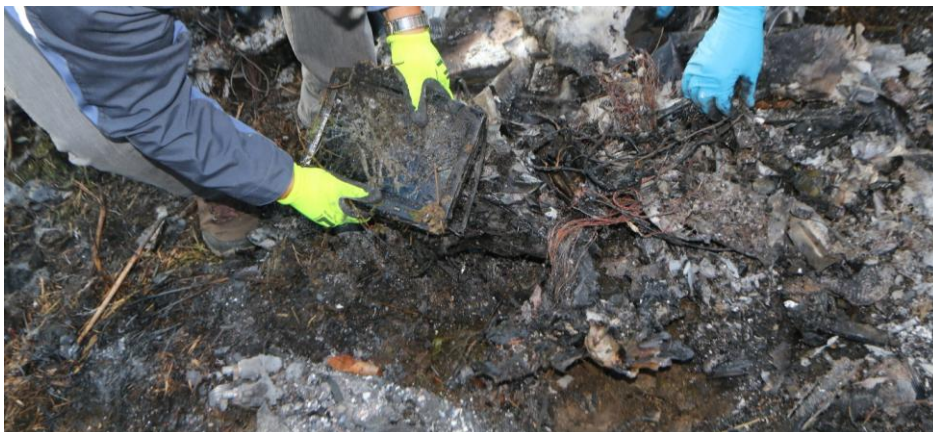
Obr. č. 8 – Obrazovka systému Garmin G3X EFIS nalezena na místě nehody
