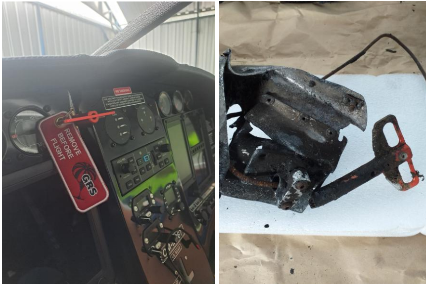
Obr. č. 11 – Rukojeť pro aktivaci záchranného balistického padákového systému (vlevo – instalace na palubní desce, rukojeť v zajištěném stavu, vpravo – odjištěná rukojeť)
