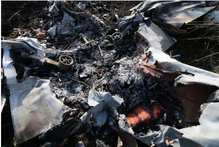
Obr. č. 12 – Požárem seškvařený padák záchraného balistického padákového systému v trupu za pilotní kabinou
